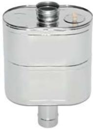
Бак печной предназначен для нагрева воды. Нагрев воды происходит за счет передачи тепловой энергии исходящих газов теплогенерирующего аппарата. Устанавливается в качестве стартового элемента дымохода на адаптер.
