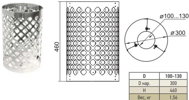
Сетка для камней предназначена для фиксации и нагрева камней на одностенной трубе дымохода. Нагрев камней происходит за счет передачи тепловой энергии исходящих дымовых газов теплогенерирующего аппарата. Сетка для камней защищает от воздействия инфракрасного излучения. Изготавливается из нержавеющей стали без сварных соединений. Устанавливается на одностенную трубу дымохода L1000 диаметром от 100 до 130 мм.
