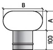
Тройник овал Моно неутепленный предназначен для изменения направления дымового канала на 87° и обслуживания дымохода - ревизии, чистки, отвода конденсата.
