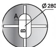
Зонт предназначен для защиты дымового канала от атмосферных осадков. Зонт является окончанием дымовой трубы.
