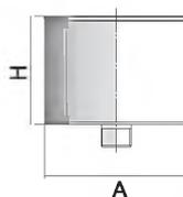
Конденсатоотвод предназначен для сбора и отведения конденсата, образовавшегося в дымовом канале. Конденсатоотвод устанавливается в нижней части дымохода, фиксируется с помощью трубного хомута.
