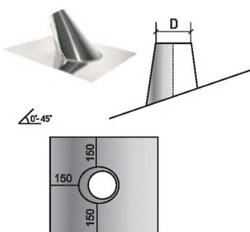
Проход кровли предназначен для перекрытия отверстия при прохождении дымохода через кровлю здания. Образующийся зазор между трубой дымохода и конусом прохода кровли необходимо закрывать фартуком.
